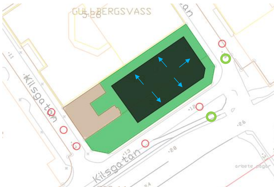
Figur 15 Schematisk översikt av ett förslag på hur ett grönt tak kan anläggas om byggnaden på Kilsgatan 10 bevaras. Svart färg representerar takyta, grön färg representerar yta för grönt tak (50% av det totala planområdet) och gröna cirklar visar servispunkter för möjliga anslutningar av stuprör. Blå pilar visar möjlig avrinningsriktning. Takutformning är ännu inte bestämd, och exakt placering av det gröna taket kan ses över i framtida skede.
