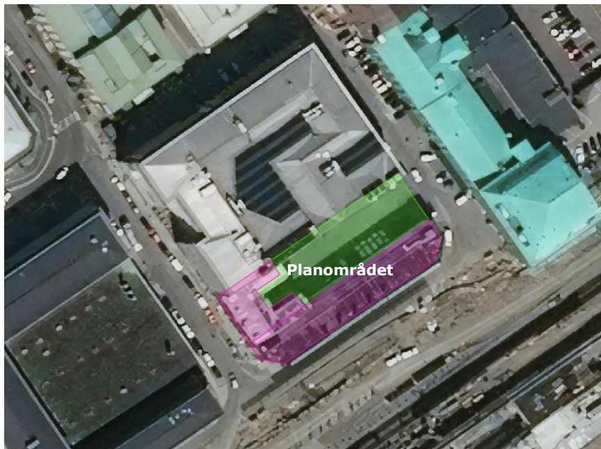
Figur 11. Markanvändning före utbyggnad. Grönfärgad yta representerar parkering och rosa yta representerar takyta. Markanvändningen efter ombyggnation är endast takyta på hela planområdet.
